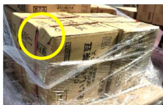
バンド食込みによる破損
